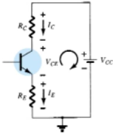
Fig. 13: Collector–emitter loop.
